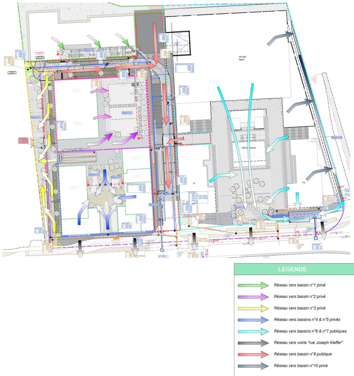
FIGURE 3 : Extrait du plan APD\_EXT\_BEI\_01\_MAS\_PDM\_111\_Concept d'assainissement
